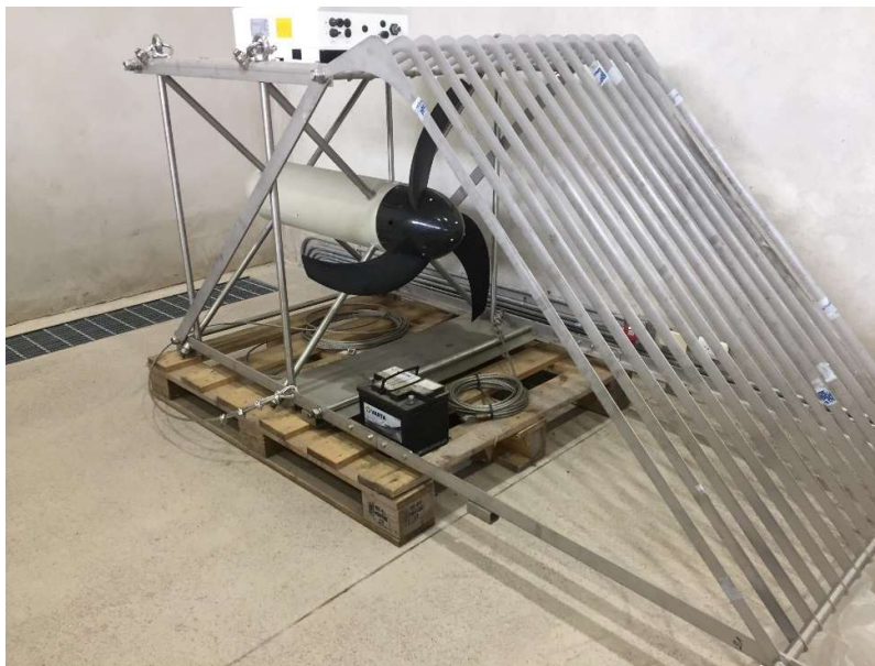
Gráfico No. 18. Turbina mino hidro de 5kw ubicados en el río Tomebamba siendo utilizado como generación de energía en épocas de invierno. Cantón Cuenca. Provincia Azuay. Fuente: Fotografía realizada por los autores de este análisis de caso. [10, mayo, 2018].
