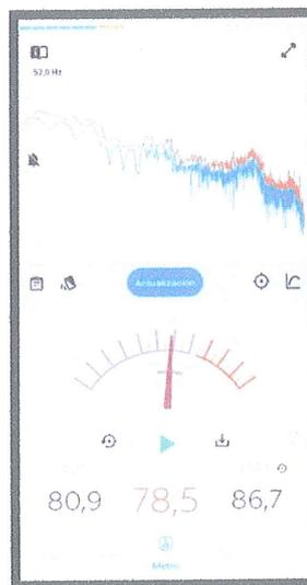
**Imagen 2:** Capture de pantalla del sonometro en la que se demuestra la intensidad sonora en el sector 1, en el momento que marcó 78.5 decibeles debido a que paso de vehiculos que se dirigen al equipamiento de salud produciendo alto cogestionamiento y probocando una molestia en el sistema auditivo. (2022).
