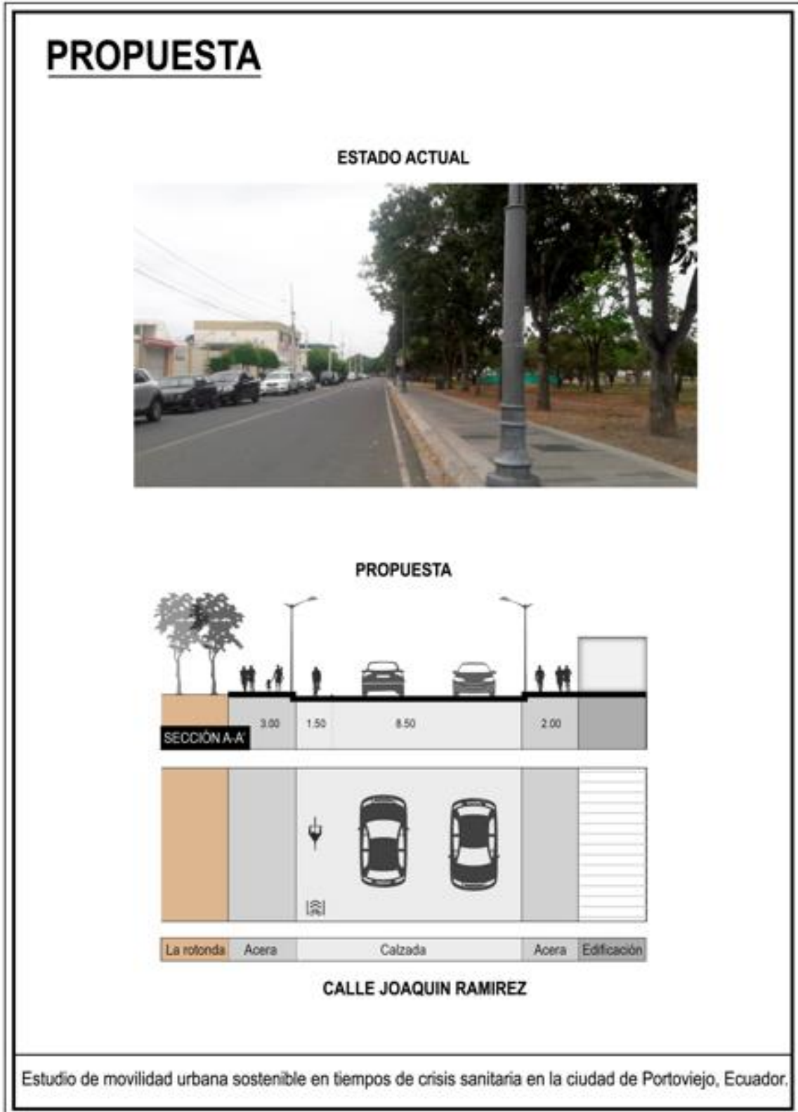
Figura 10. Detalle de corte A-A, en los puntos establecidos para la propuesta
