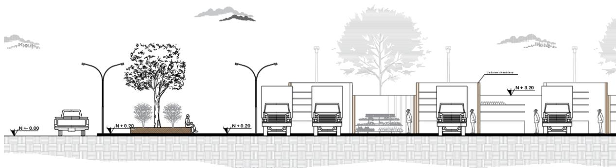
*Nota.* Segmento del corte transversal donde muestra las alturas de los módulos y conjugación con el exterior. Autores del trabajo de titulación (2021)
