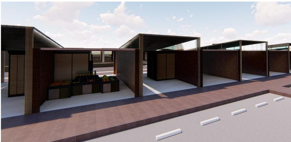
La ubicación de los locales está de manera lineal, no obstante, en su cubierta se presentan cubiertas inclinadas con una caída alternada y ventanales de vidrio (Figura 70). Por otra parte, la utilización de policarbonato en cubiertas curvas ubicadas en los ingresos hacia el Mercado, con una estructura metálica. (Figura 71)
