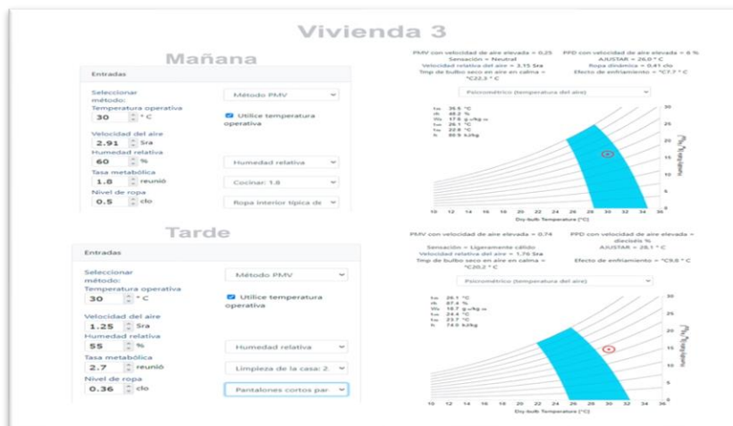
Figura 3. Datos de la evaluación en el interior de la vivienda 3 con ayuda del software herramienta de confort térmico CBE de la Universidad Berkeley de California, elaborado por el autor de esta investigación, 2021.
