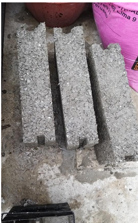
Gráfico No. 89. Elaboración del bloque ecológico. (2020). Fuente: Fotografía realizada por los autores de este análisis de caso.
