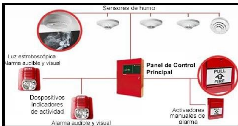
Figura 23. Sistema de detector de humo
