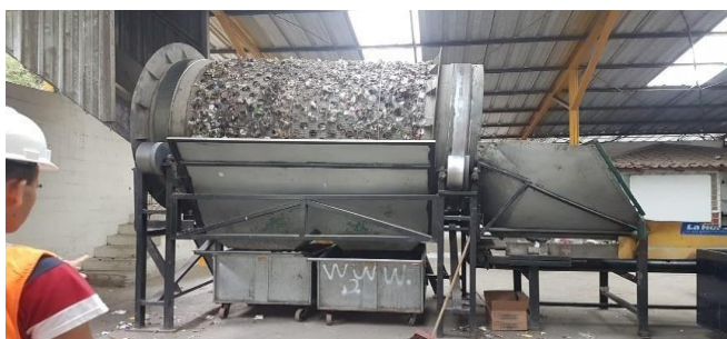
Gráfico No 16. Fotografía de la criba tambor del centro de gestión de Manejo de Residuos Sólidos del cantón Loja. República del Ecuador. Fotografía tomada por los autores de este Análisis de Caso [10, junio, 2019].
