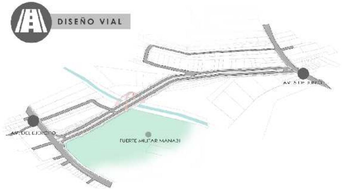
*Gráfico No. 132.* Isometría y esquema sobre el diseño vial de la propuesta. Fuente: Imagen elaborada por los autores del presente análisis de caso, (2019).
