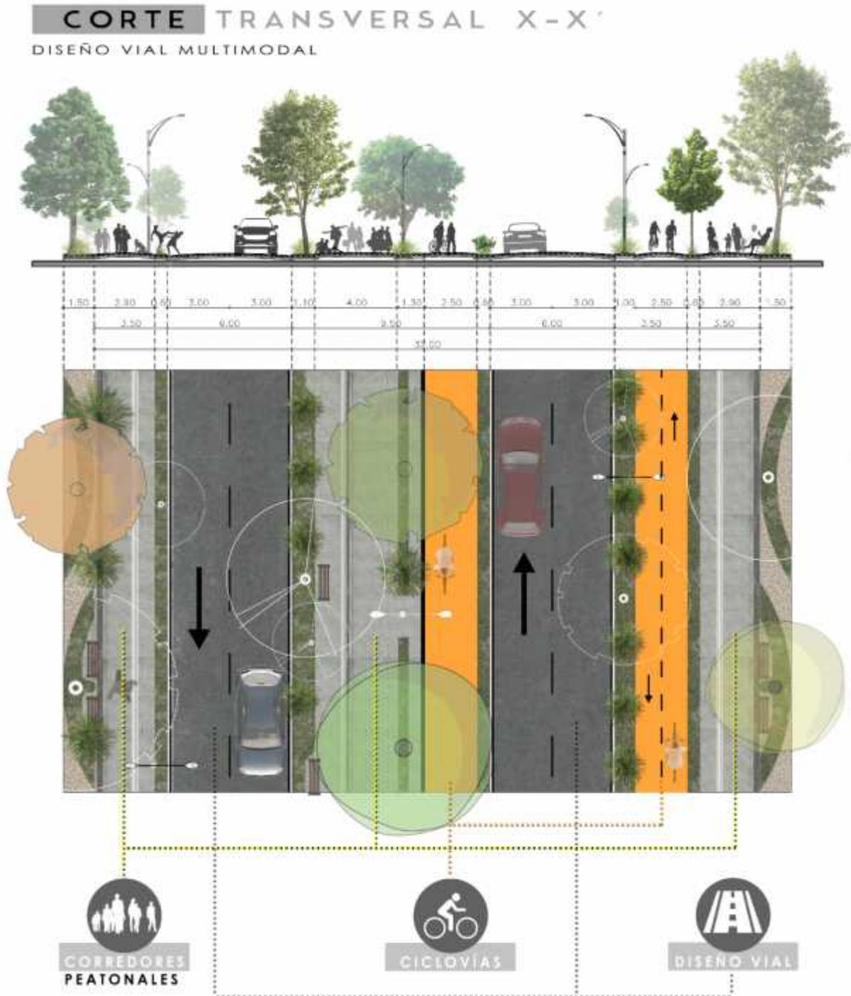
Gráfico No. 135. Corte transversal en la cual se aprecia el diseño vial multimodal y sus respectivas medidas. Fuente: Imagen elaborada por los autores del presente análisis de caso, (2019).
