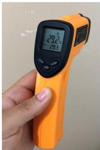
*Gráfico No.52.* Pirómetro (INFRARED THERMOMETER).
