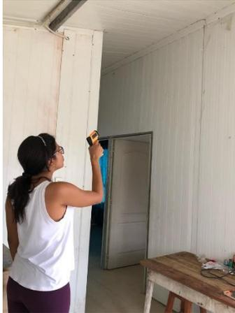
*Gráfico No.19.* Medición de temperatura por medio del pirómetro. Cantón Rocafuerte. Provincia de Manabí.
