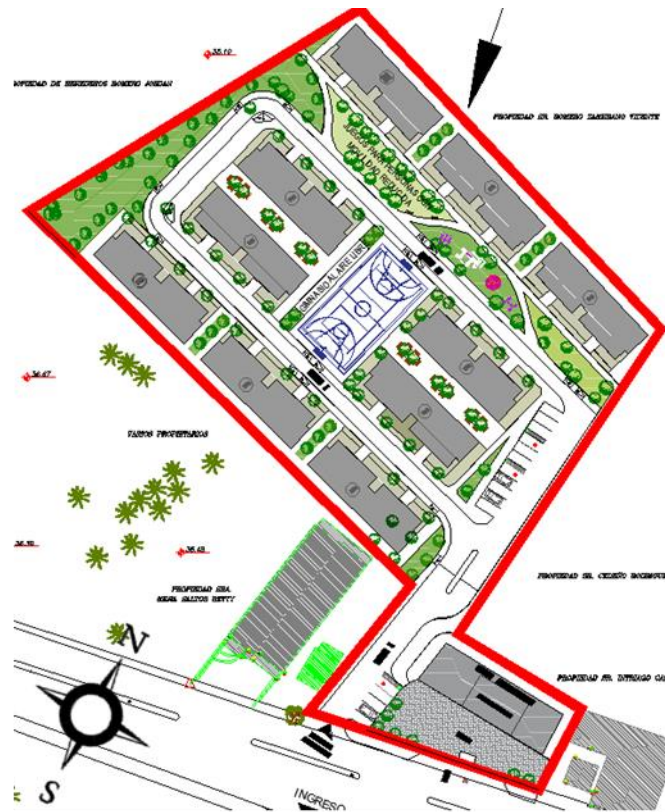
Gráfico No. 25. Implantación del reasentamiento Pichota-Rocafuerte Fuente: Dibujo realizado en el programa AutoCAD por la empresa pública Casa para todos
