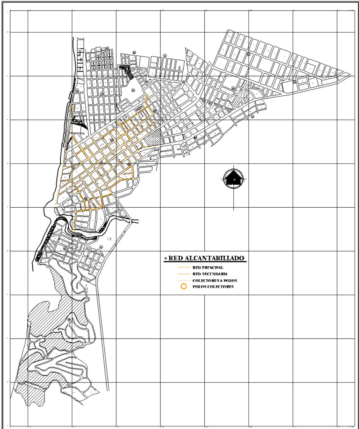
Ilustración 53: Red de alcantarillado sanitario de Pedernales
