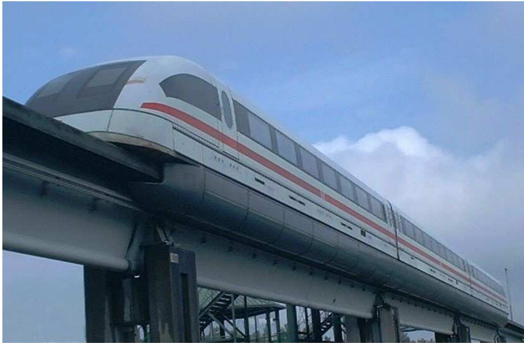
Ilustración 81: TransRapid en Alemania, monoriel levitado magnéticamente
