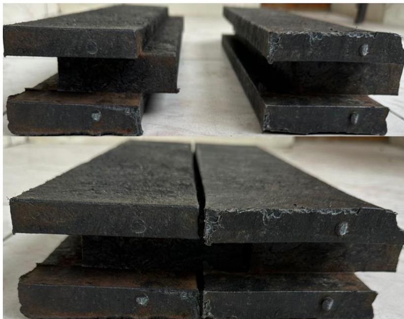
*Nota.* Vista lateral de la unión de muestras de paneles termoplásticos. *Fuente.* Fotografía tomada por los autores de la investigación
