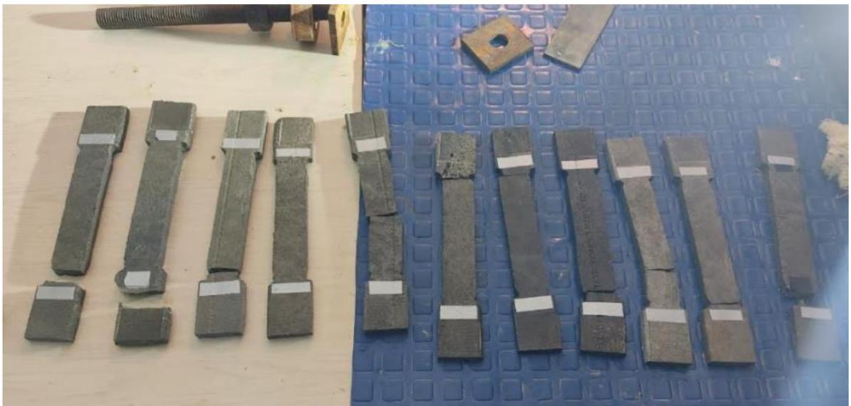
*Nota.* Ensayo en laboratorio de resistencia a tracción de la muestra del material. *Tomado de* La empresa de maderas plásticas ECOPLAST 2K.
