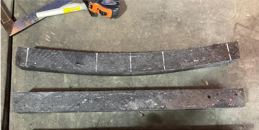
*Nota.* Comparación de una viga no ensayada y una viga ensayada a la resistencia de flexión. *Fuente.* Fotografía tomada por los autores del análisis de caso en el Laboratorio Tecnisuelos en la ciudad de Portoviejo. [20 junio, 2023].
