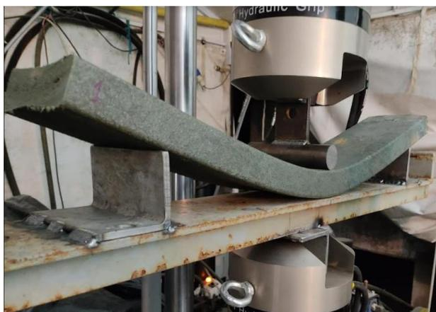
*Nota.* Ensayo en laboratorio de resistencia a flexión de la muestra del material. *Tomado de* La empresa de maderas plásticas ECOPLAST 2K.
