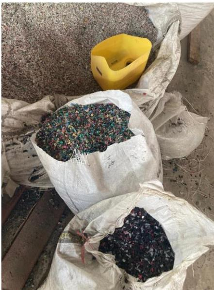
*Nota.* Materia prima de plásticos seleccionados, polietileno de alta densidad, polietileno de baja densidad y polipropileno. *Fuente.* Fotografía tomada por los autores de la investigación. [6, junio, 2023].
