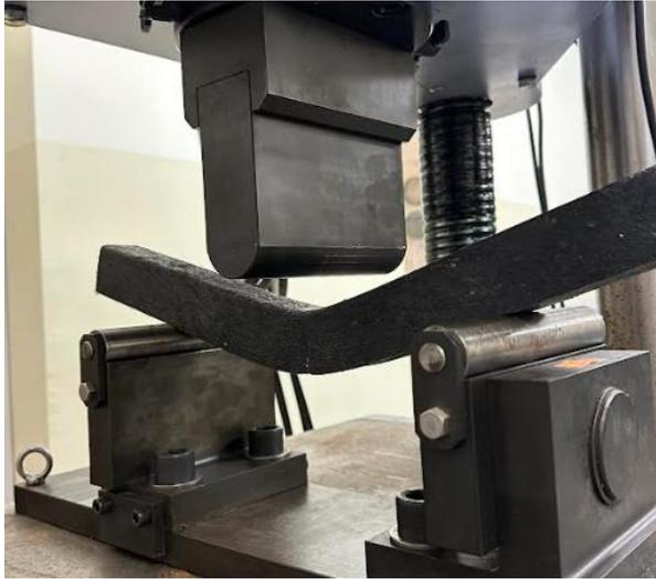
*Nota.* Muestra de viga a base de polímeros termoplásticos post-ensayo de laboratorio de resistencia a flexión. *Fuente.* Fotografía tomada por los autores de la investigación en el Laboratorio Hormigón, Suelos y Materiales “Bolívar Ortiz Logroño” en la ciudad de Manta. [20 julio, 2023].
