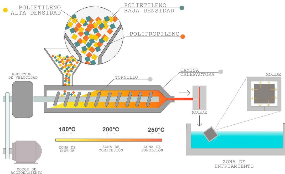
*Nota.* Proceso de fundición de los materiales mediante distintas temperaturas. *Fuente.* de los autores de la investigación. [28, junio, 2023].
