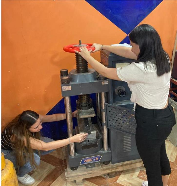
*Nota.* Ensayo de resistencia a flexión de la muestra del material para el Panel Termoplástico Industrial Reciclados. *Fuente.* Fotografía tomada por el auxiliar de esta investigación en el Laboratorio Tecnisuelos en la ciudad de Portoviejo. [20 junio, 2023].
