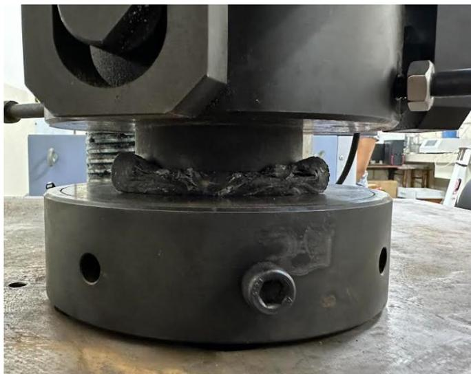
*Nota.* Muestra 2 de cubo a base de polímeros termoplásticos en prueba de laboratorio de resistencia a flexión. *Fuente.* De los autores de la investigación en el Laboratorio Hormigón, Suelos y Materiales “Bolívar Ortiz Logroño” en la ciudad de Manta. [20 julio, 2023].
