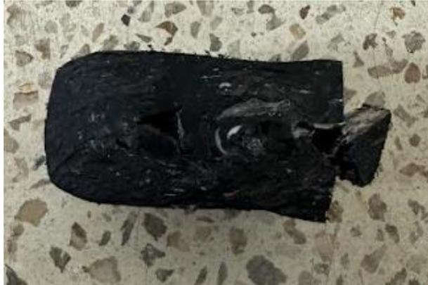
*Nota.* Muestra 1 de cubo a base de polímeros termoplásticos en prueba de laboratorio de resistencia a flexión. *Fuente.* Fotografía tomada por los autores de la investigación en el Laboratorio Hormigón, Suelos y Materiales "Bolívar Ortiz Logroño" en la ciudad de Manta. [20 julio, 2023].
