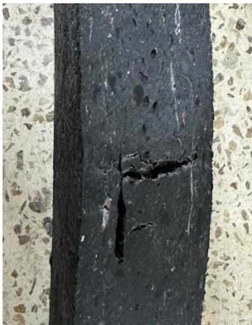
*Nota.* Rotura de muestra de viga a base de polímeros termoplásticos post-ensayo de laboratorio de resistencia a flexión. *Fuente.* Fotografía tomada por los autores de la investigación en el Laboratorio Hormigón, Suelos y Materiales “Bolívar Ortiz Logroño” en la ciudad de Manta. [20 julio, 2023].
