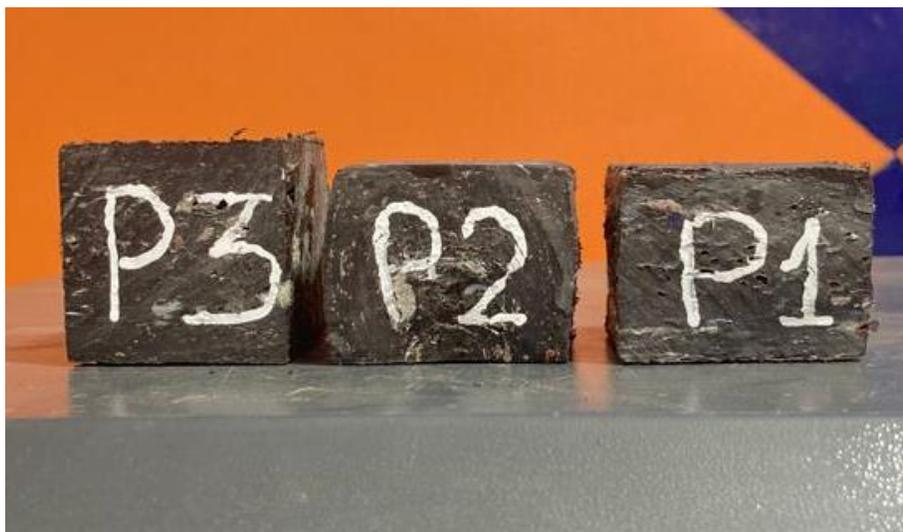
*Nota.* Comparación de un cubo no ensayado y dos cubos ensayados a la resistencia de compresión. *Fuente.* Fotografía tomada por los autores del análisis de caso en el Laboratorio Tecnisuelos en la ciudad de Portoviejo. [20 junio, 2023].
