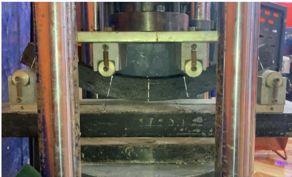
*Nota.* Muestra de viga a base de polímeros termoplásticos en prueba de laboratorio de resistencia a flexión. *Fuente.* Fotografía tomada por los autores de la investigación en el Laboratorio Tecnisuelos en la ciudad de Portoviejo. [20 junio, 2023].
