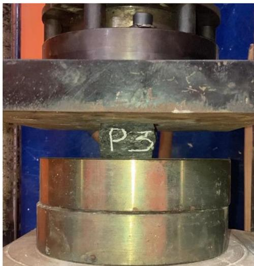
*Nota.* Registro del ensayo en laboratorio, resistencia a la compresión del cubo del material para el Panel Termoplástico Industrial Reciclados. *Fuente.* Fotografía tomada por los autores del análisis de caso en el Laboratorio Tecnisuelos en la ciudad de Portoviejo. [20 junio, 2023].
