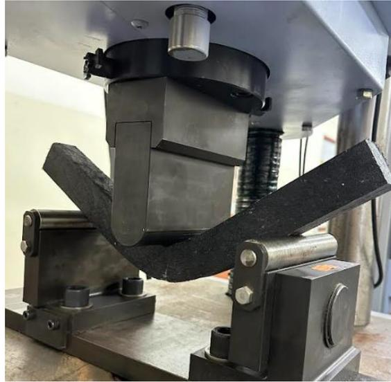
*Nota.* Muestra de viga a base de polímeros termoplásticos en prueba de laboratorio de resistencia a flexión. *Fuente.* Fotografía tomada por los autores de la investigación en el Laboratorio Hormigón, Suelos y Materiales "Bolívar Ortiz Logroño" en la ciudad de Manta. [20 julio, 2023].
