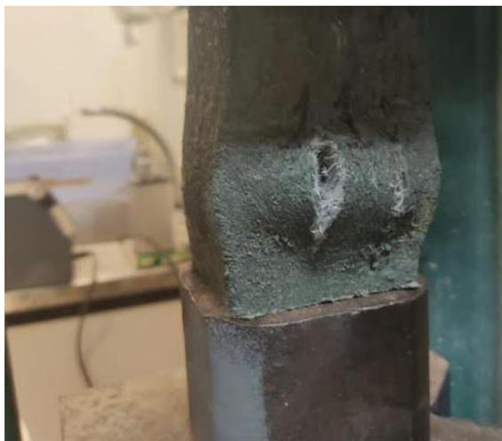
*Nota.* Ensayo en laboratorio de resistencia a compresión de la muestra del material.
