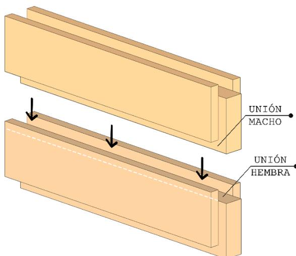
*Nota.* Tipo de ensamblaje aplicado para los paneles TIR. *Fuente.* Elaborado por los autores de la investigación. [11 agosto, 2023].
