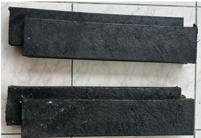
*Nota.* Dos muestras de paneles prefabricados a base de polímeros. *Fuente.* Fotografía tomada por los autores de la investigación
