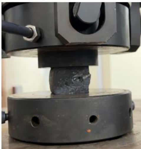
*Nota.* Muestra de cubo a base de polímeros termoplásticos en prueba de laboratorio de resistencia a flexión. *Fuente.* Fotografía tomada por los autores de la investigación. [20 julio, 2023].
