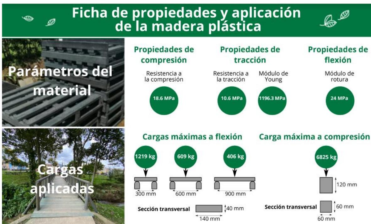
*Nota.* Registro de datos recopilados en los ensayos en laboratorio de resistencia a flexión, compresión y tracción de la muestra del material para la elaboración de equipamientos urbanos en Medellín. Tomado de La empresa de maderas plásticas ECOPLAST 2K.
