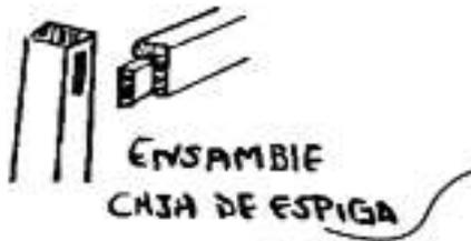
En este tipo de ensamble, una pieza de madera tiene una cavidad en forma de caja y la otra tiene una espiga que encaja en esa caja
