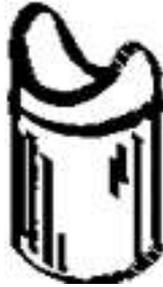
La boca de pescado se utiliza para unir el extremo de una caña rolliza a otra perpendicularmente y así tener una unión más ja se puede modelar una oreja que es un segmento corto de caña ubicado en el punto más bajo de la boca, y que sirve para insertar en una perforación de la otra caña. Debe ser realizado a 2 o 3 cm del nudo inmediato inferior.
