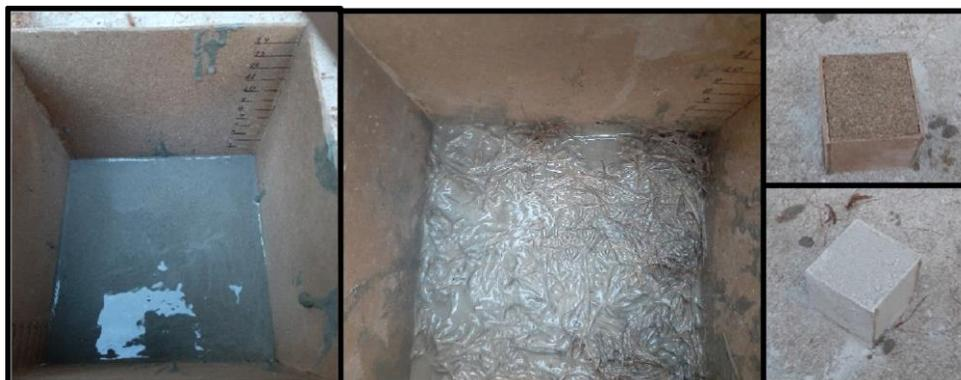
Nota: Se muestran los resultados finales de la medición de volumen producido por las dosificaciones junto con los moldes que contienen arena y cemento. Imagen tomada por los autores del proyecto. (2022)
