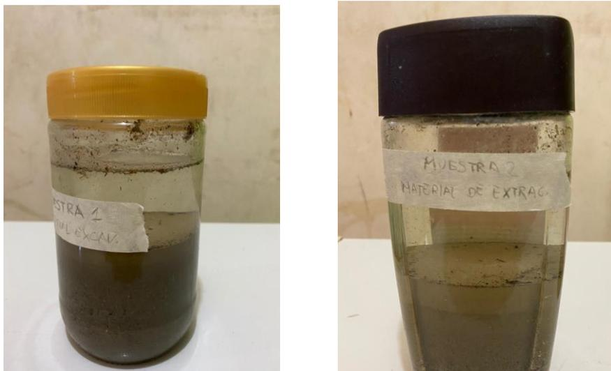
Nota. Estudio de granulometría empírico en frasco de vidrio, el cual se lleva a cabo para determinar los porcentajes de grava, arena y tierra que existe en el suelo donde se construirá el espacio habitable. El estudio fue realizado con la tierra extraída del lugar donde se llevó a cabo la excavación para cimentación y el sitio donde se iba a extraer el material para rellenar los sacos. Debido al contenido alto de limo dentro de esta muestra, se descartó el uso de ese material.
