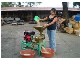
Figura 3 *Máquina de pilar arroz*
