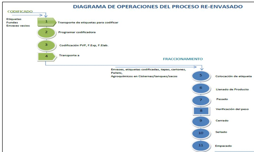
Figura 33 Diagrama de operación del proceso de Re-embalaje
